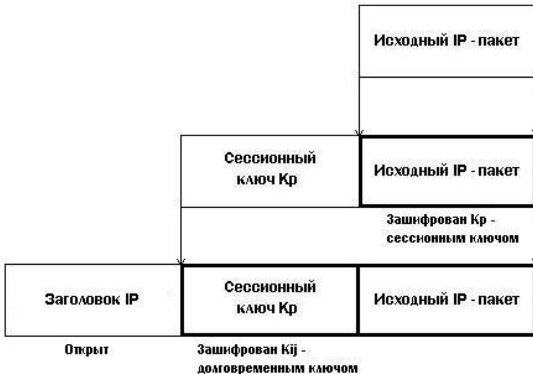
Рис. 4.12. Схема создания SKIP-пакета
